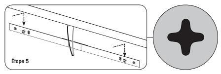
Alianez les trous en forme de serrure (voir l'encart) situés derrière l'enceinte sur les têtes de vis aui dépassent sur le support, puis en faisant un mouvement de haut en bas, fixez l'enceinte sur le support.
