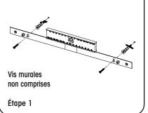
Placez le support et assurez-vous qu'il est au niveau. Marquez les deux trous de vis du centre. Percez les trous de guidage, puis enfoncez fermement les boulons d'ancrage dans la cloison sèche et vissez. Vissez ensuite les vis à tête plate : NE VISSEZ PAS COMPLÈTEMENT À CE POINT—laissez les têtes de vis dépasser légèrement.
