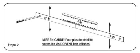
Le support est doté de fentes *(voir l'illustration)*, pour permettre un réglage, le cas échéant. Vérifiez à nouveau pour vous assurer que le support est au niveau. Marquez les trous de vis extérieurs.
