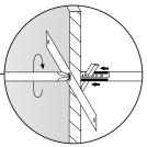
MISE EN GARDE! Toutes les vis doivent être insérées en ligne droite et entièrement serrées pour s'assurer que les boulons d'ancrage fonctionnent correctement.
