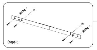
Enlevez les deux vis à tête plate (voir l'illustration). Percez les trous de guidage intérieurs, puis enfoncez fermement les boulons d'ancrage dans la cloison sèche et vissez. Insérez maintenant les quatre vis à tête plate et serrez.
