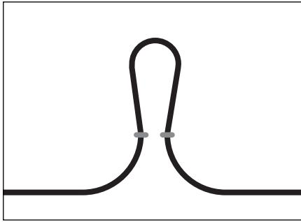
2. Recommandé : Utilisez un attache-fil (non inclus) pour garder la boucle intacte et servir de décharge de traction.
